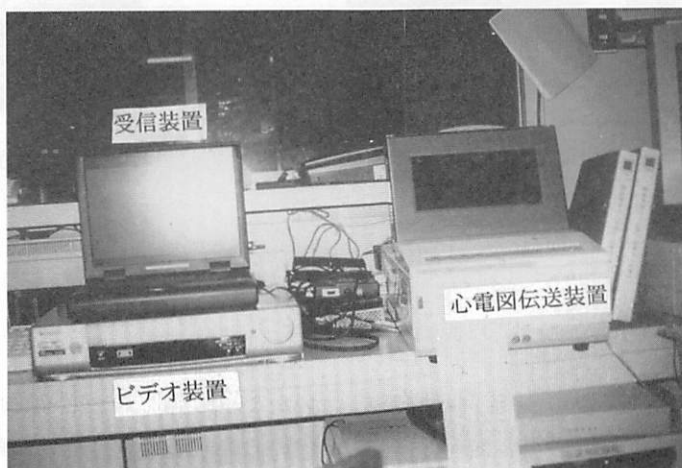
写真3 心電図伝送装置と並んで設置された受信装置とビデオ装置
