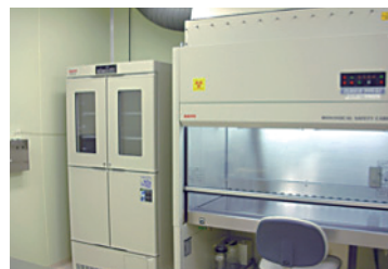
フリーザ付き薬用冷蔵庫(左側)と バイオハザード対応安全キャビネット(右側)
