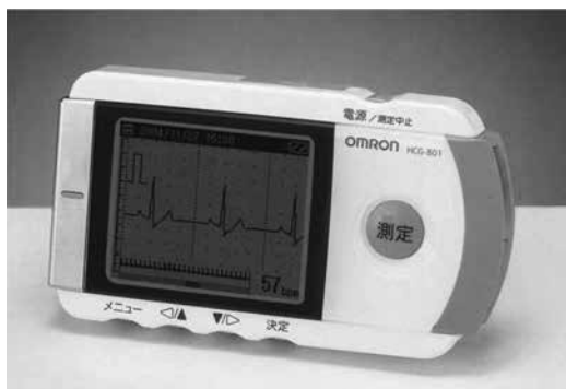
図3A 固定電極(押し当て式)のイベント心電計 電極を貼り付けなくてよいので、日常生活を制限することなく心電図が記録できる。しかし、スイッチを押した後だけの記録なので異常波形を取り逃すこともある(イベント後)。
