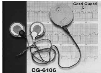
図2A ループメモリー式のイベント心電計 4)
