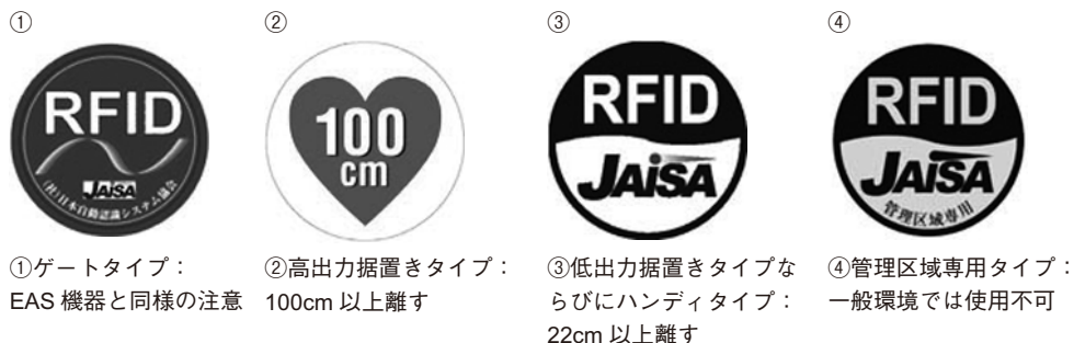
図2 RFID機器の識別ステッカー
