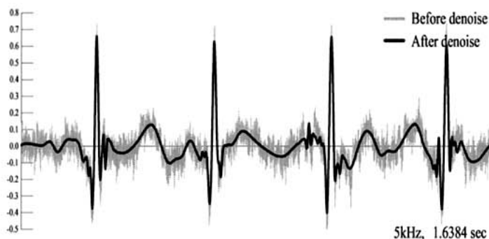
図 3 図 2 で単離された fECG (ica4) の後半の 1.6384 秒についてのウェーブレットによるノイズ除去前後での比較 灰色はノイズ除去前、黒い線のグラフがノイズ除去後。ノイズ除去後には、胎児心電図波形が明瞭となる。
