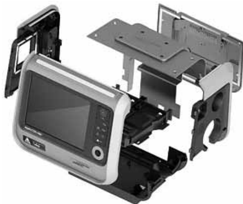
図1 Hamilton 社製 MR1 の筐体 アルミニウムとマグネシウム合金でできている （日本光電工業より提供）
