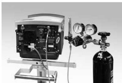
図 VELA (背面) への酸素ボンベからの低圧酸素入力
