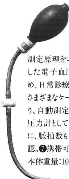
測定原理をコロトコフ法におき、臨床での実用・応用性を追求した電子血圧計です。広い病態に適応でき、操作も簡便なため、日常診療をはじめ集団検診、病棟での定時血圧測定など、さまざまなケースで利用できます。主な仕様①コロトコフ法により、自動測定。②オシロメトリック法も併用。③聴診法における、圧力計としても使用可能。④聴診間隙にも対応。⑤血圧と同時に、脈拍数も自動測定。⑥脈の強弱は脈波ディスプレイで確認。⑦携帯可能なポケットサイズ。本体サイズ：58×21.5×92mm・本体重量：104g(充電池を含む)⑧水銀を使用せず、造りも堅牢。
