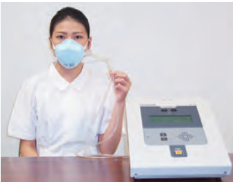
▲労研式マスクフィッティングテスターによる漏れ率の測定
