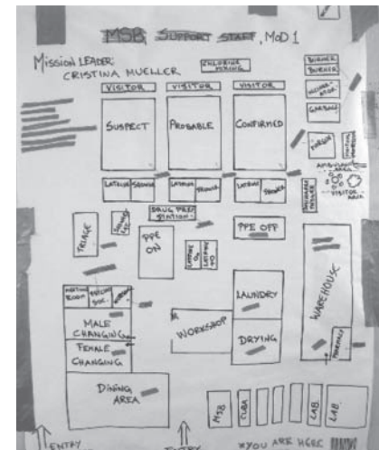
図2 旧防衛省エボラ治療ユニットの見取り図（スウェーデン市民災害庁の支援チームによる）
