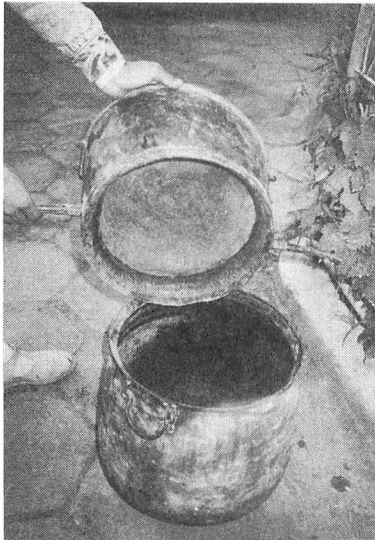
図 2 葉城ウイグル医医院の蒸露剤製造装置 上の容器をはずした状態
