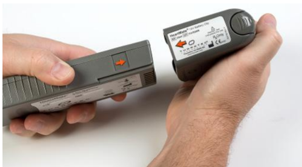
図 2-21 バッテリーとバッテリークリップのオレンジ色の矢印
