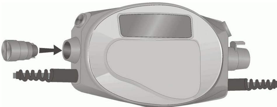
図 2-6 バッテリーモジュールの挿入
