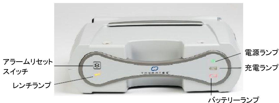
図 2-18 パワーモジュールのランプとスイッチ
