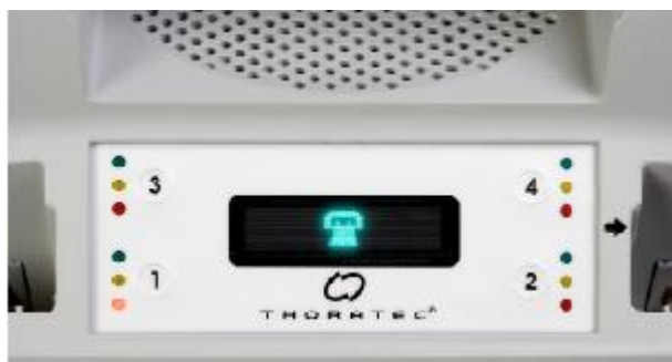
図 2-34 1 番の充電ポケットの故障メッセージ。赤色の充電ランプが点灯。
