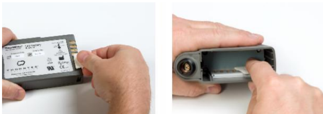
図 2-22 バッテリーとバッテリークリップの端子の清掃
