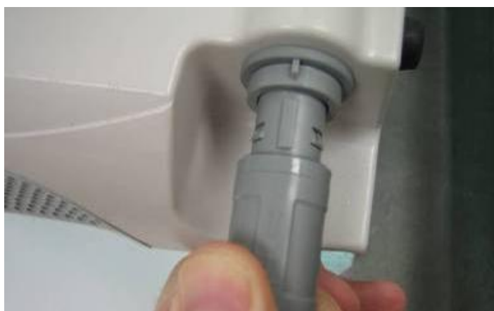
図 2-38 パワーモジュールとの接続
