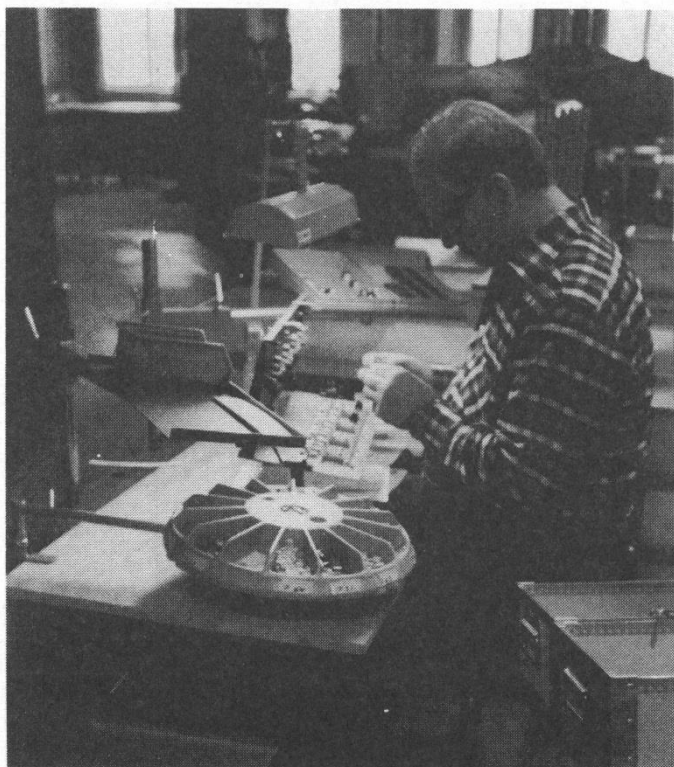
写真3-2-3 プリント基盤への部品装着作業
