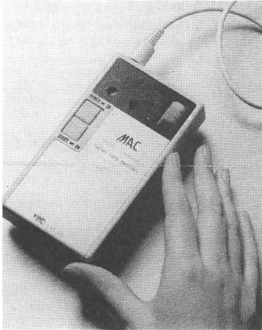
写真 2-4-1 半導体素子を応用した心拍数長時間記憶装置
