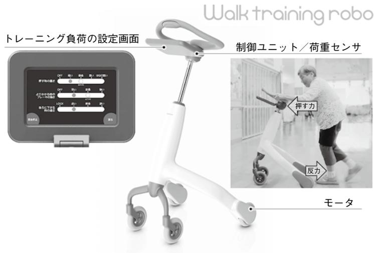
図1 歩行トレーニングロボット「Walk training robo」
