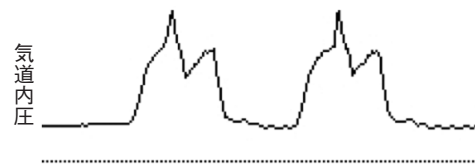
図17 立ち上がりが急すぎるPSVの気道内圧波形 振動が見られる。
