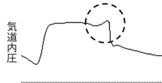
図19 サイクルオフが小さすぎるPSVの気道内圧波形 吸気後半に圧上昇が見られる。
