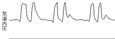
図18 PSVの二段吸気 患者の1回の吸気中に人工呼吸器が2回サポートしている
