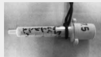
図 12 25mL シリンジ外筒に 7.5mm チューブのスリップジョイントを接続
