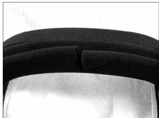
図2 使用には問題とならない部分の破損
