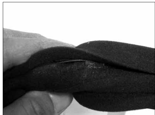
図3 皮膚損傷や水疱形成の原因となる見逃されやすい部分の破損
