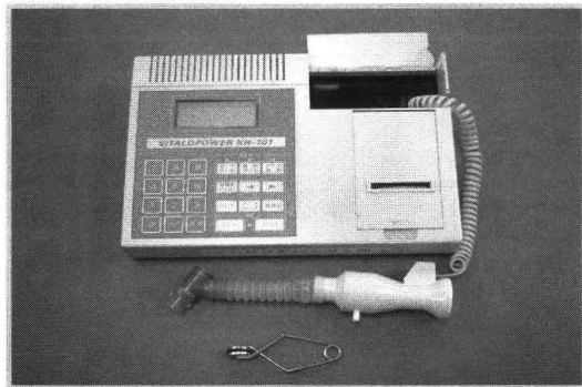
図1 呼吸筋力測定機器(Chest社製バイタロパワー KH-101) 本機器は本体とセンサー部分で構成されている。圧力センサーが内蔵されているセンサーと被検者を連結することで、被検者が吸気努力した際に生じる陰圧を圧センサーが感知し、本体より読み取ることで吸気圧の測定が可能となる。
