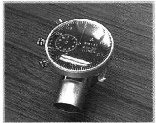
図2 ガス流量計RM121 ガス流量計内を通過する気体(被検者の呼気)によって、内部の扁平な羽根車が回転する。その回転に対応した流量(換気量)がパネルに表示される。
