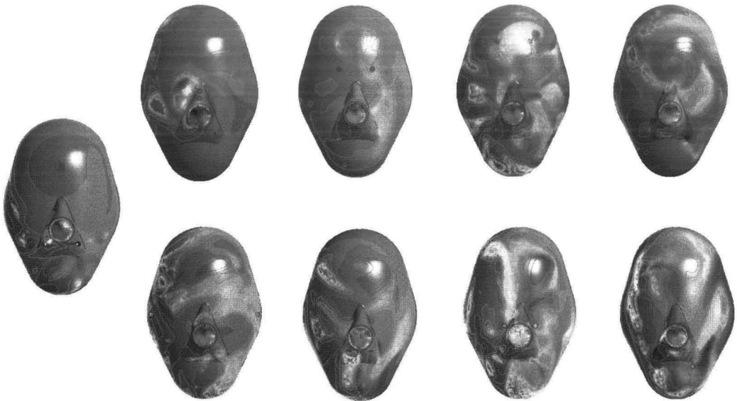
図8 CFDによる呼気中のCO 2 volume fraction (CO 2 容積分率)
