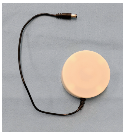
図 1. spinning permanent magnet (SPM) 機器 直径 7.8 cm、高さ 2.1 cm であり、その質量はわずかに 108 g である.
