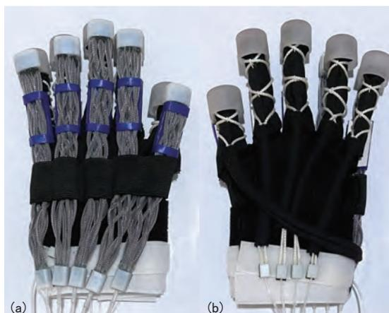
図 1. 開発したウェアラブルロボット背側 (a)、掌側 (b)
