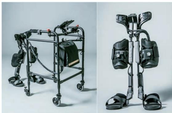
**図 2.** WPAL (Wearable Power-Assist Locomotor) 脊髄損傷者の歩行再建を目的とした歩行支援ロボット。内側型装具に似たフレームに両側股関節・膝関節・足関節の合計 6 個のモータを搭載している。モータ制御回路やバッテリーを搭載した専用歩行器を用いることによって、安全性を担保するとともに、患者の負担重量が軽減される。歩行器に設置された 2 つのレバースイッチと 2 つのボタンスイッチにより、患者 1 人で全ての操作が可能である。
