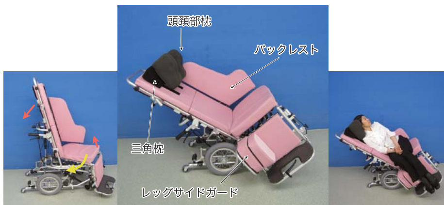
図2. 開発した Swallow chair (SC) 写真左：リクライニング・ティルト機能を有する（赤色矢印）、さらに30度60度90度の座面回転機能を有する（黄色矢印）。 写真中央・右：リクライニング30°・体幹右回旋・頭部左回旋位を調整。 頭頸部安定のための頭頸部枕、背部や腰部安定のための三角枕やバックレスト、下肢の支えとなるレッグサイドガードが装備されており、正確かつ安定した姿勢を簡便に短時間で設定できる。
