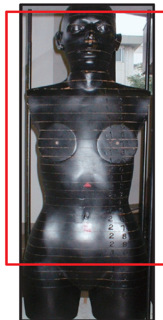
図 2. ランドファントム ランドファントムの TLD 装着範囲を赤枠内に示す。
