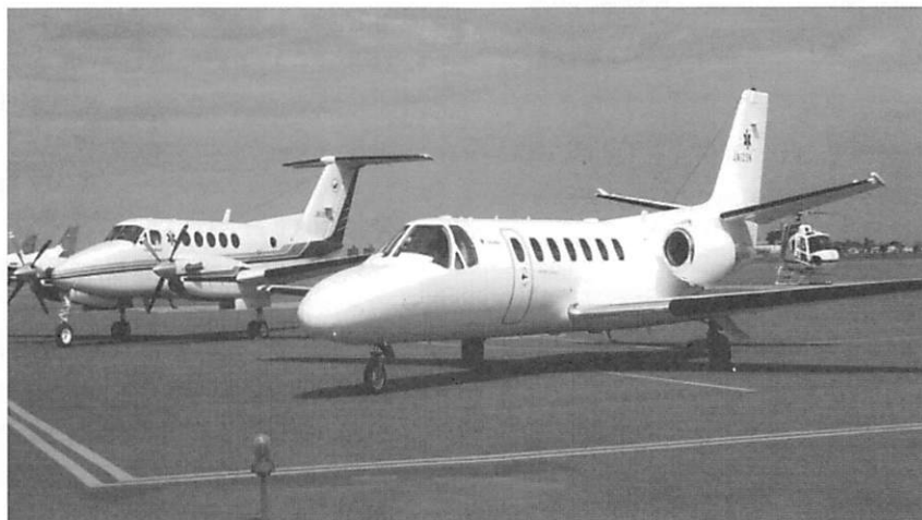
図5 ジェット機(サイテーションC560)とターボプロップ機(Beech craft King Air 200)
